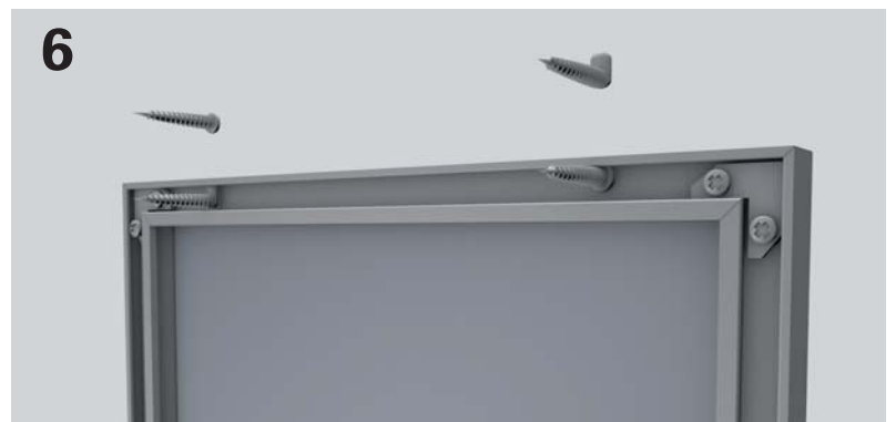
Die Aufhängung erfolgt mit den beigefügten Aufhängern, durch Schrauben, Haken oder einfach Nägel. Die Aufhängungspunkte sollten – besonders bei größeren Formaten – möglichst dicht bei den Montagewinkeln sitzen. Dadurch wird ein Durchbiegen der Leisten vermieden. Sehr wichtig: Beim Auseinanderbauen eines CONTUR-Alurahmens unbedingt als erstes alle Andruckfedern entfernen!
